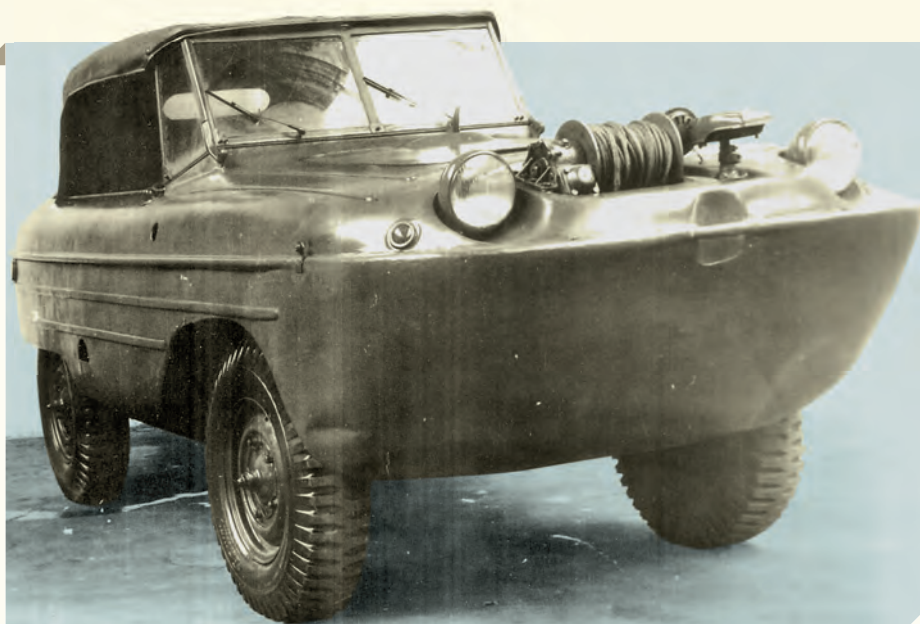
Один из пяти собранных экземпляров опытной амфибии ŠKODA 972.
